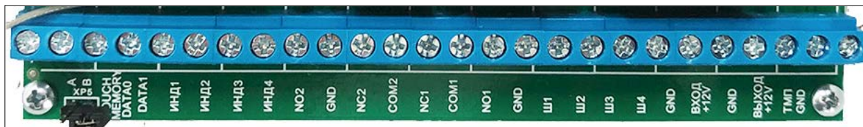
Рисунок 3 Расположение и обозначение контактов клеммных колодок
