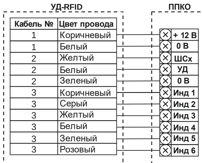
Рисунок 2– Типовая схема подключения УД-RFID к ППКО
