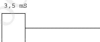
Рисунок А.1 - Форма сигнала, выдаваемого устройством в абонентскую линию в режиме "ТЕСТ 1"
