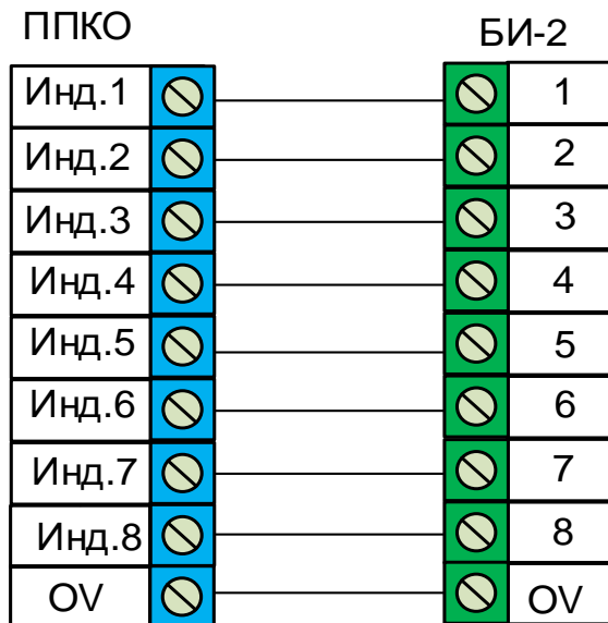
Рисунок 1 – Схема подключения БИ-2 к ППКО
